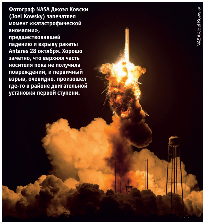
Одна из серии фотографий взрыва ракеты Antares, сделанной Джоэлом Ковски. В отсутствие тяги двигателей ракета начала падать, ударились о землю и разрушилась, превратившись в огромный огненный шар.
